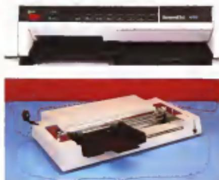
Il ricco pannello di controllo, l'alimentatore automatico di fogli singoli di 130 fogli e la stampante con i coperchi inclinati per l'accesso alla testa di stampa ed ai cartoni
